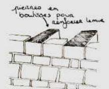
Dans la composition, on essaye de varier la profondeur des pierres pour renforcer la solidité en chevauchant les éléments structurels dans plusieurs plans.
